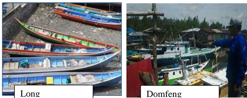
Gambar 6. Perahu longboat dengan mesin tempel dan perahu domfeng dengan mesin dalam
