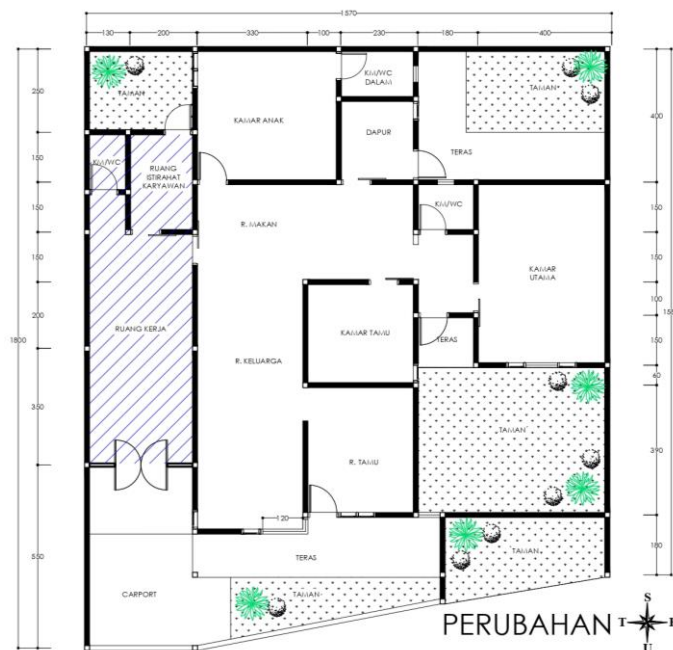
Gambar 9. Denah Perubahan Rumah Tinggal 4
