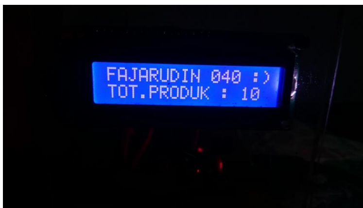
Gambar 9. Tampilan LCD ketika menghitung wafer stick
