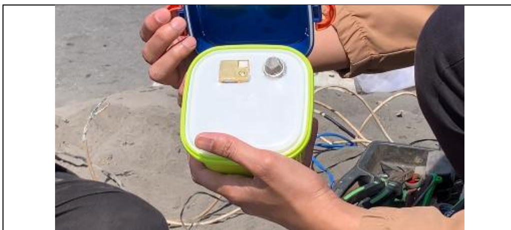
Gambar 5. Pemasangan dan pengujian sensor gas \text{CO}_2 dan \text{H}_2\text{S} dengan Sistem IoT
