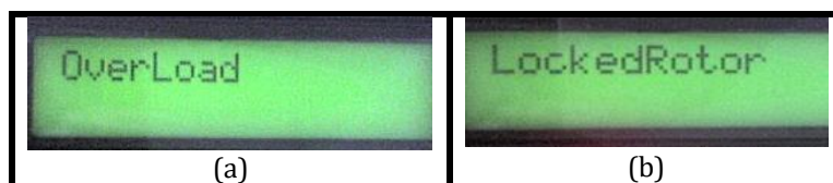
Gambar 17. Tampilan LCD Saat Terdeteksi a) Gangguan Over Load , b) Gangguan Locked Rotor
