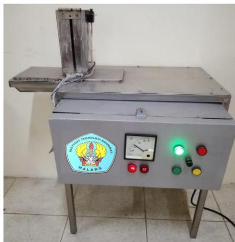
**Fig. 25** Rebung Chopper Tool
