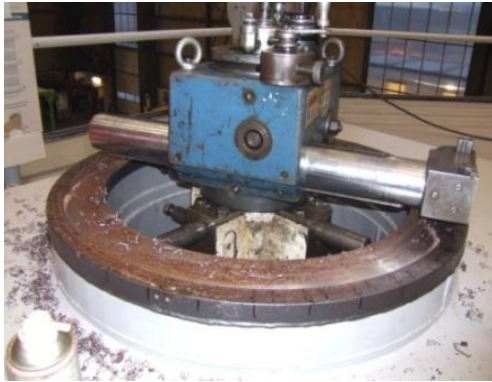
Gambar 8. Penyekrapan Yang Dilakukan Untuk Offset Plane Terhadap Error Tilt Total
