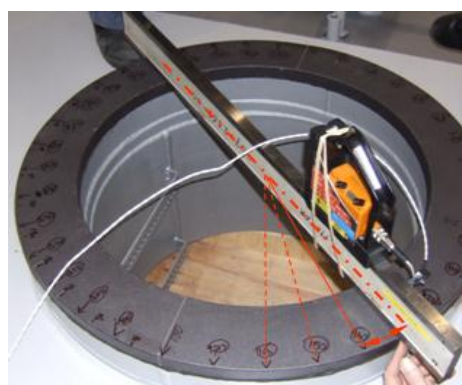
Gambar 7. Pengukuran Di Kapal Terhadap Tilt Pondasi Meriam
