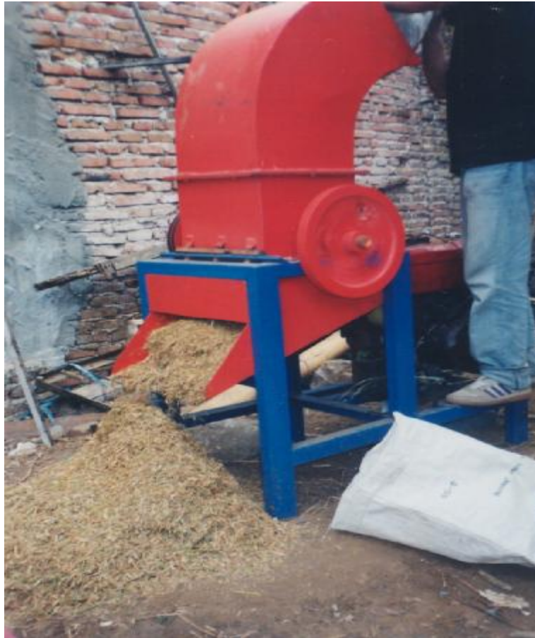
Gambar 2. Mesin Pencacah (Pemotong) Sampah Secara Mekanik yang dioperasikan di lapang
