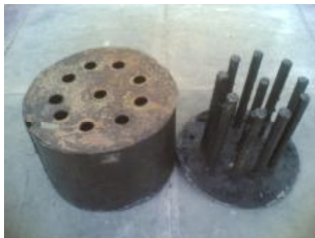
Gambar 4. Cetakan Briket Batubara Silinder Berlubang
