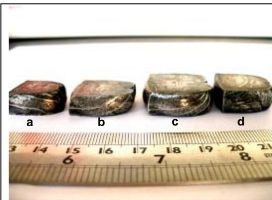
**Gambar 4. Hasil Tempa Paduan Dengan Si Untuk Variasi Temperatur : a. 1050°C, b. 1100°C, c. 1150°C, d. 1200°C selama 30 menit. Tanda Panah Menunjukkan Terjadinya Retakan**
