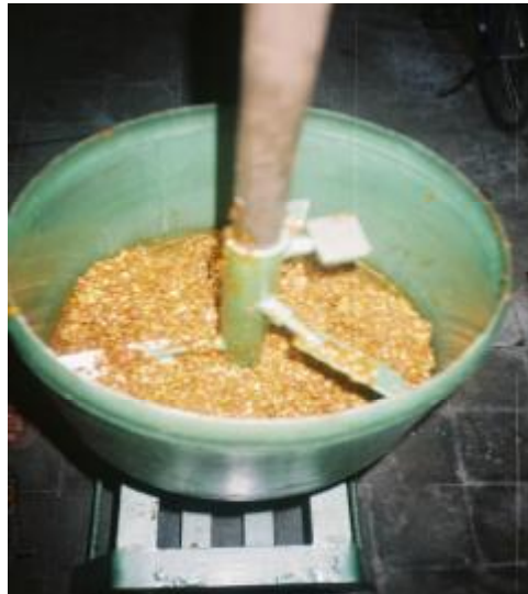
Gambar 5. Implementasi Mesin Adonan Bahan Baku Sambal Kacang Secara Mekanis
