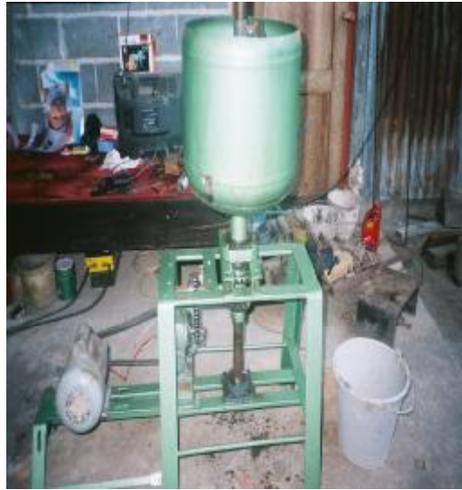
Gambar 4. Mesin Adonan Secara Mekanis Dengan Pengaturan Otomatis
