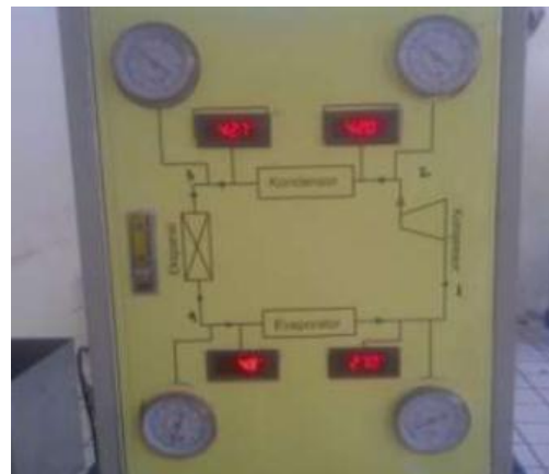
Gambar 2. Alat Uji Sistem Refrigrasi
