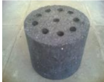
Gambar 5. Briket Batu Bara Bentuk Silinder Berlubang
