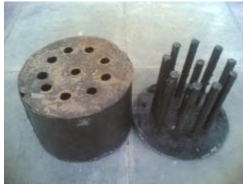
Gambar 7. Cetakan Briket Batubara Silinder Berlubang
