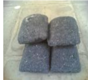
Gambar 6. Briket Batu Bara Bentuk Telur
