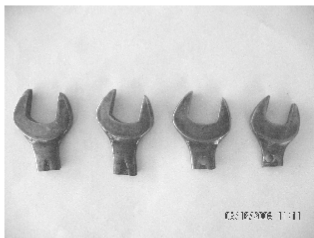
Gambar 3. Sampel Uji Setelah Dipotong
