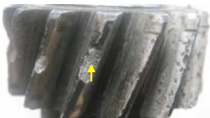
Gambar 9. Analisa Permukaan Patahan Roda Gigi Transmisi
