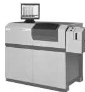
Gambar 4. Mesin Uji Komposisi Kimia dengan Mesin Quantometer Sumber : PT. Ispat Indo Desa Kedungturi, Taman, Sidoarjo
