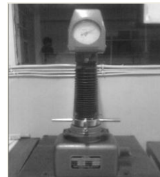
Gambar 3. Mesin Rockwell Hardness Tester Sumber : Laboratorium Uji Logam Jurusan Teknik Mesin FT. UNMER Malang
