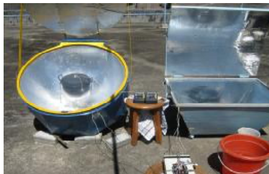
Gambar 1. Pengujian Power Cooker Kompor Surya
