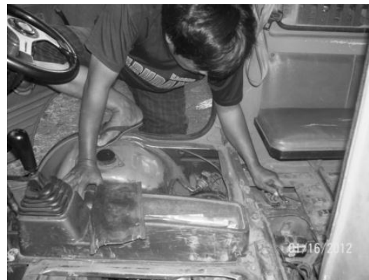
Gambar 7 . Pemasangan HHO Elektrolisa pada Angkutan Kota
