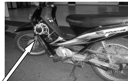
Gambar 3. Pengujian pemasangan alat HHO pada Sepeda Motor
