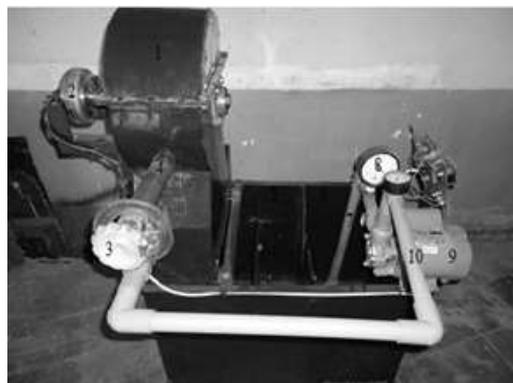
Gambar 4. Instalasi Turbin Air Jenis Pelton
