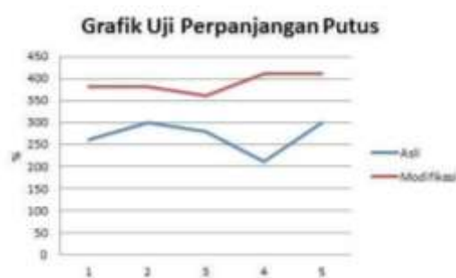
Grafik 3. Grafik Hubungan Perpanjangan Putus Timing Belt Asli Dengan Modifikasi
