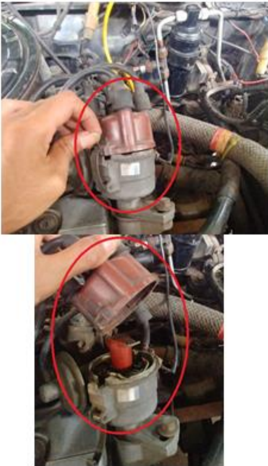
Gambar 9. Pelepasan Tutup Delco (Sumber: dokumentasi pribadi)
