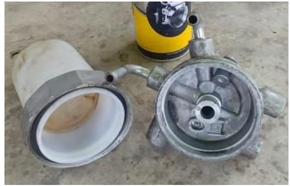
Gambar 8. Sedimenter dan Fuel Elemen yang sudah Dipisahkan (Sumber: dokumentasi pribadi)
