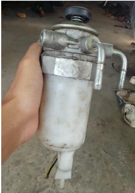
Gambar 7. Sedimenter yang telah Dilepas dari Selang dan Penopang (Sumber: dokumentasi pribadi)
