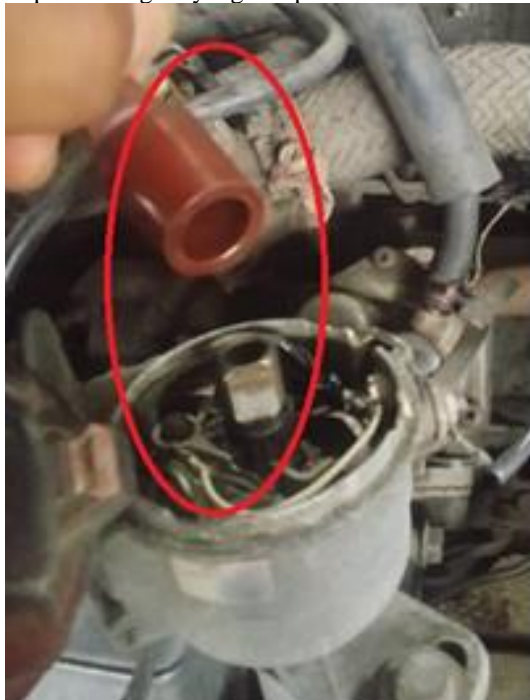
Gambar 10. Pelepasan Bagian Cam Distributor (Sumber: dokumentasi pribadi)
