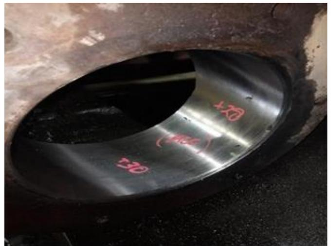
**Gambar 5** Lubang hasil repair yang telah selesai
