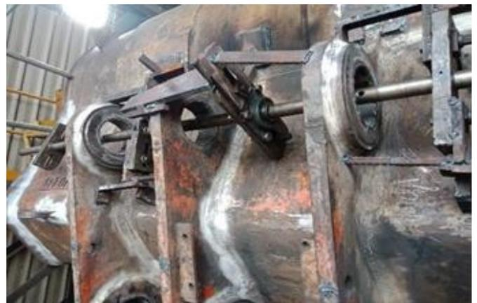
**Gambar 4** Proses pemasangan *bracket line boring*
