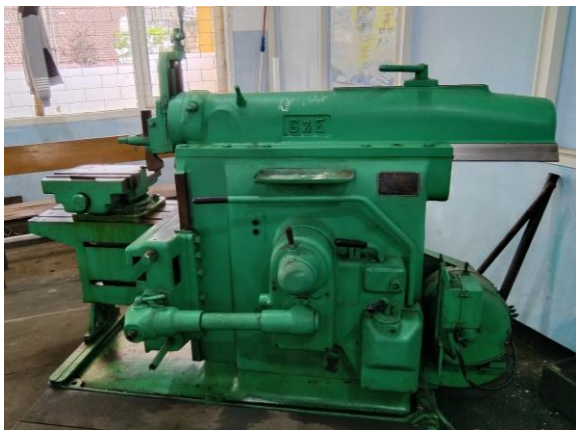
Gambar 6. Mesin sekrap yang digunakan untuk proses sekrap tembaga
