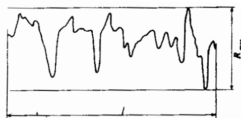
Gambar 3. Ketidakrataan Maksimum, R_{max} Atau R_y
