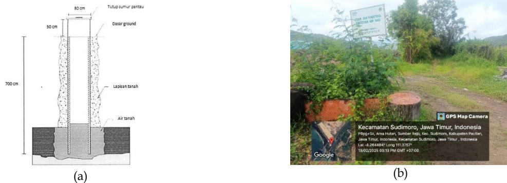
Gambar 8. (a) Desain Sumur Pantau, (b) Bak Pendeteksi Kebocoran
