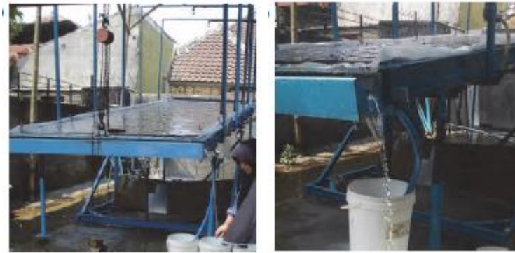
Gambar 1. Alat Uji Simulator Hujan
